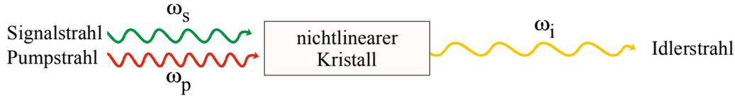
Abbildung 3.1: Schematische Darstellung der Differenzfrequenzerzeugung. Pump- und Signalstrahl werden in einen nichtlinearen Kristall eingestrahlt. Dort wird die Differenzfrequenz, auch Idlerstrahl genannt, generiert.
