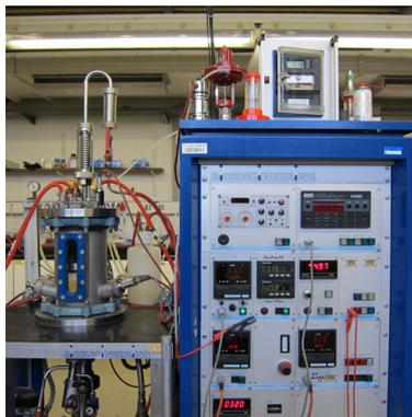
**Abbildung 6.3:** Laborfermenter L1523 der Firma Bioengineering AG.
