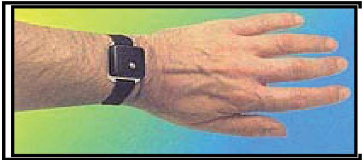
**Abb. 2.3** Accelerometer an Handgelenk
