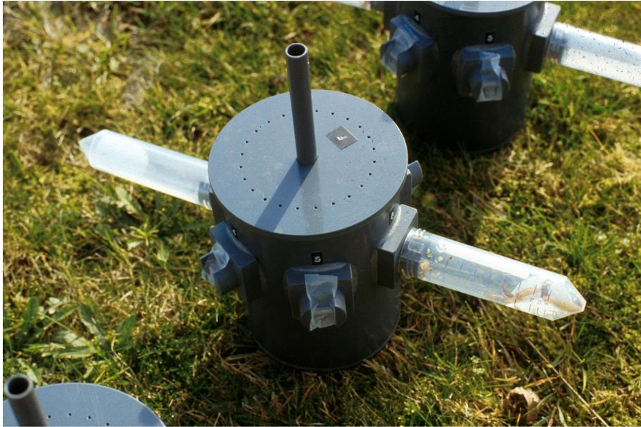
**Abb. 3:** Zylindrische Olfaktometer mit zwei Testkammern. Die übrigen vier Törchen der Öffnungen wurden verschlossen.
