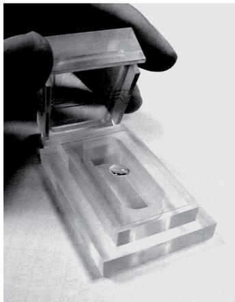
*Abbildung 3.2: Plexiglasblock zur Erzeugung eines Endothelschadens. Oben der Stempel mit drei mittigen Drähten, unten der Plexiglasblock mit aufgelegtem Deckglas. Unmittelbar vor dem Strömungsversuch am Endothelschaden, wurde der Zuchtnapf vom Deckgläschen entfernt und das Deckgläschen in die vorgefräste Vertiefung des Plexiglasblocks eingelegt.*
