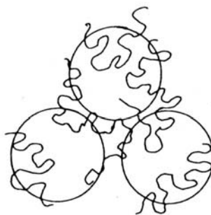
Abb. 3.5-6: Flockung durch Polymerbrücken zwischen Kolloidteilchen (nach [197])
