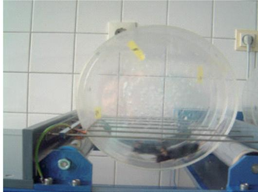
**Abbildung 2.2.9.2:** Foto der Laufradmaschine, in dem ein Laufrad von zwei sich drehenden Walzen angetrieben wird.
