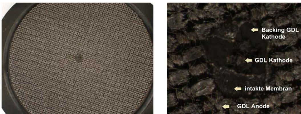
Abbildung 125: Zustand der Membran nach Ausbau, Rechts: Aufsicht auf Anode mit Defekt, Links: Mikroskopaufnahme vom Loch in der Membran.
