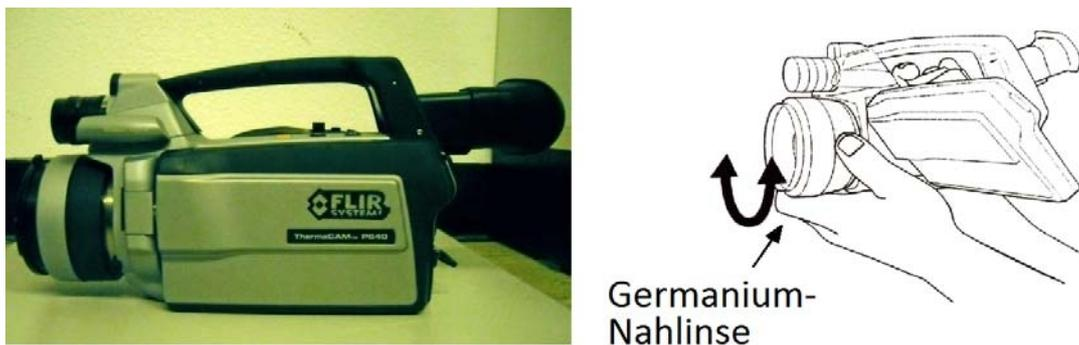
Abbildung 71: Wärmebildkamera FLIR-P640 (640x480 Pixel, 8x-Zoom) mit aufschraubbarer Germanium-Nahlinse
