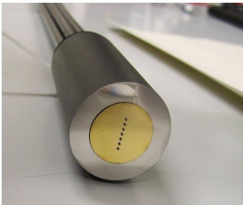
Abbildung 49: monochromatorseitiges Ende des Lichtleiterbündels des ersten Aufbaus
