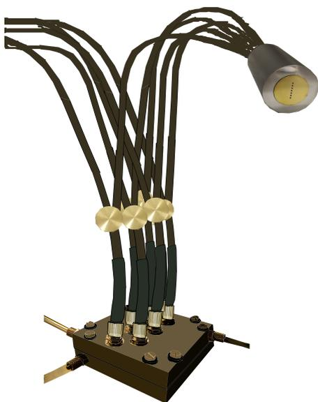
Abbildung 42: Lichtleiterbündel montiert auf einem Modellmäander; auf der linken Seite des Bildes (nicht sichtbar) wird das Laserlicht eingekoppelt; rechts Bündelabschluss für Anschluss an die Monochromatoreinheit
