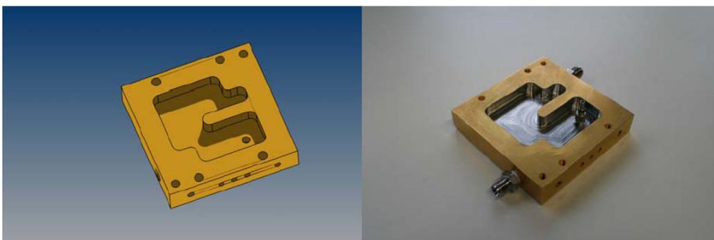
Abbildung 54: Ausfräsung der Anoden-Halbschale für die Aufnahme der SMA-Stecker (Quelle: Erich Gülzow, DLR)
