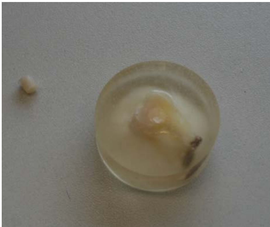
Abb. 13: Prüfkörper mit abgelöstem Kunststoffzylinder nach Messung
