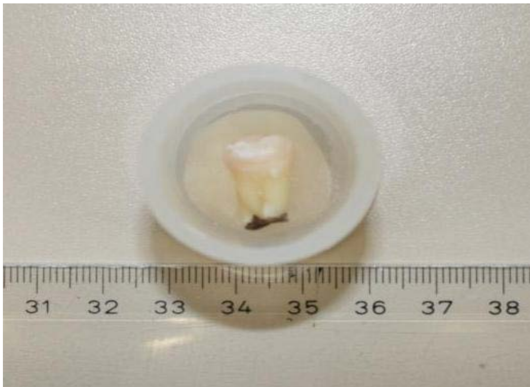
Abb. 4: Fixierung/Ausrichtung des Zahnes in der Kunststoffform
