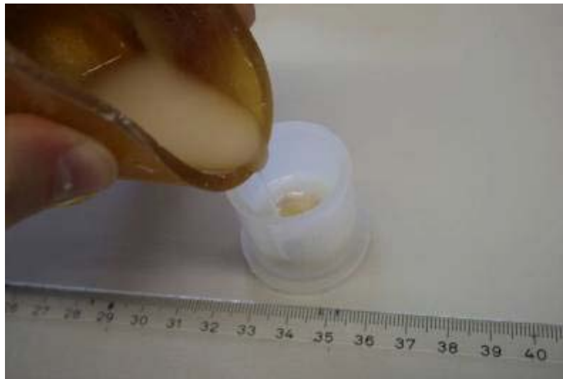
Abb. 5: Auffüllen der Kunststoffform mit Einbettkunststoff Technovit
