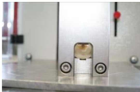
Abb. 11: Abscher-Vorrichtung mit eingespanntem Probenkörper, Ansicht frontal
