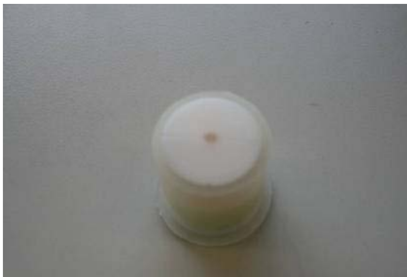
Abb. 7: Kunststoffform mit aufgebrachter Matrize
