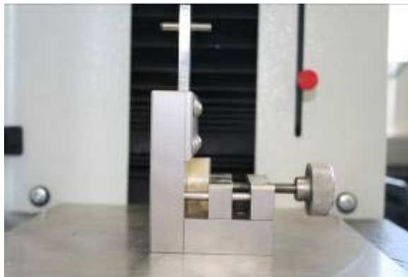
Abb. 12: Abscher-Vorrichtung mit eingespanntem Probenkörper, Ansicht seitlich
