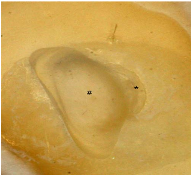
Abb. 14: Rinderzahnprobe im Dentin. Bruchmodus: Kohäsiver Bruch im Zahn. #= In die Tiefe des Zahnes gebrochene Fläche, weitaus größer als die ursprüngliche Größe des aufgetragenen Kunststoffzylinders, #= noch sichtbare Randbegrenzung des aufgetragenen Kunststoffzylinders.
