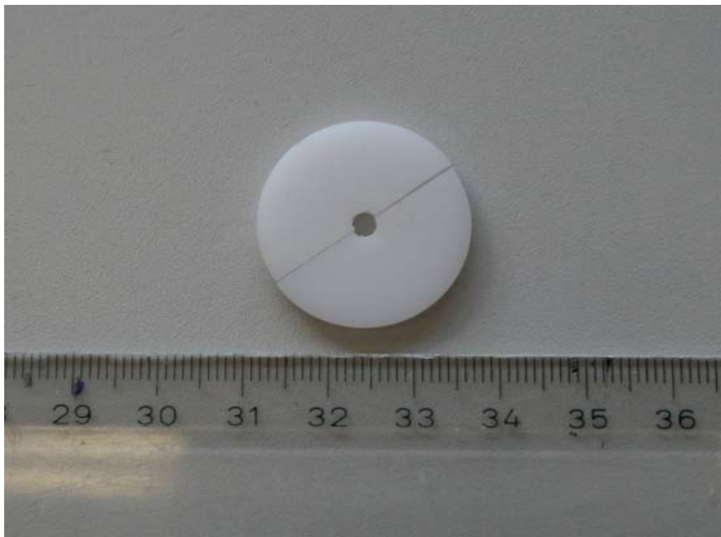
Abb. 6: Matrize zur Applikation des Kompositzylinders
