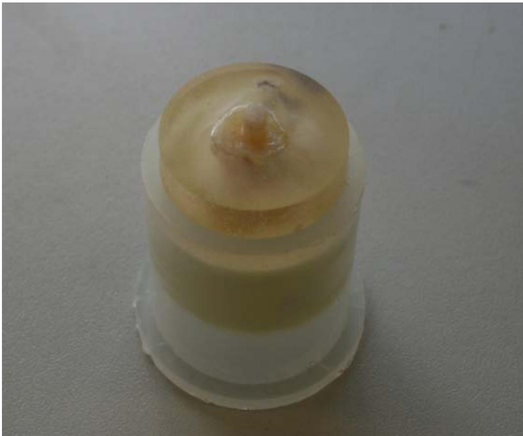
Abb. 8: Fertiggestellter Prüfkörper mit appliziertem Kunststoffzylinder
