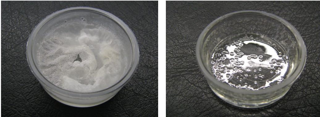
Abb. 6.7: Rückstand einer Lupamin<sup>®</sup> 9095 Lösung (links) und zum Vergleich Rückstand einer salzfreien PVAm-Lösung (rechts)
