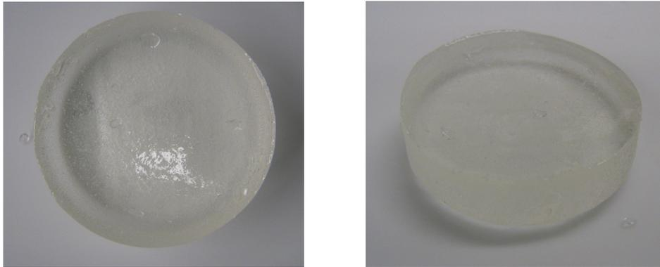
**Abb. 6.10:** PVAm Hydrogel nach der Vernetzung von Lupamin® 9095 mit Epichlorhydrin (Wassergehalt ca. 75 Gew.-%), Aufnahmen von oben und vorne
