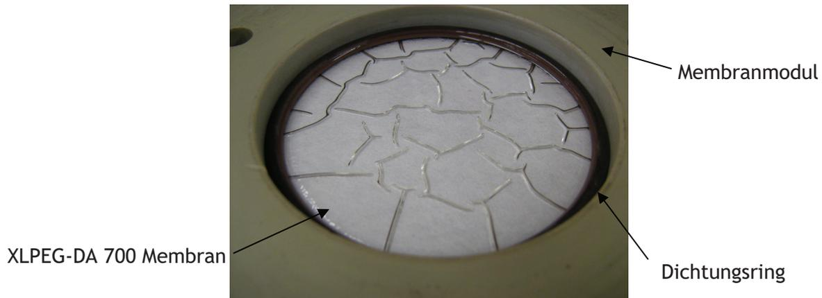
**Abb. 5.28:** Aufnahme einer stark gequollenen XLPEG-DA 700 Membran im Membranmodul des PV-Teststands nach der Benetzung mit einer Ethanol/Wasser-Mischung bei RT, Wasserkonzentration: 7,4 Gew.-%, permeatseitiges Vakuum: 30 - 45 mbar
