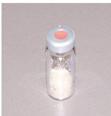
Abbildung 52: Mit dem Ganzzell-Biokatalysator E. coli BL21(DE3) pCD003 produzierte R-Mandelsäure. 1 L einer Bakteriensuspension des Ganzzell-Biokatalysators mit einer OD_{578} von 10 wurde für 120 h bei 37°C inkubiert. Als Substrat wurde 10 mM Mandelsäurenitril verwendet. Die produzierte Mandelsäure wurde mittels Ethylacetat-Extraktion extrahiert und durch Umkristallisation aufgereinigt.
