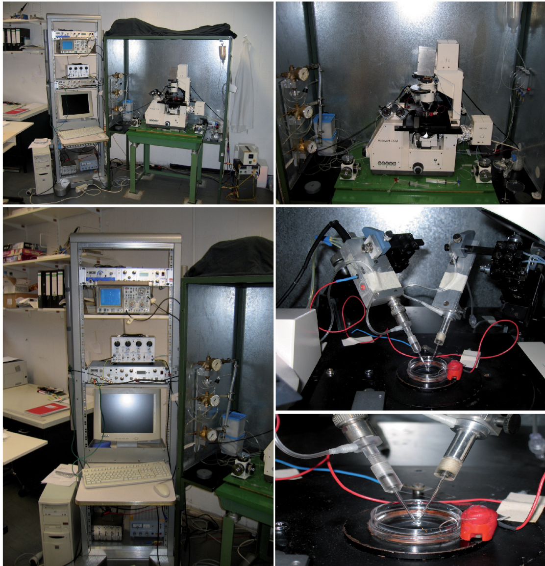
Abbildung 10: Messstand: Links ist eine Übersicht des Arbeitsplatzes sowie der Computerarbeitsplatz mit Verstärker abgebildet, rechts sind der Mikroskopiertisch mit mechanischen Feintrieben sowie zwei Vorverstärker mit Patchelektroden zu erkennen.
