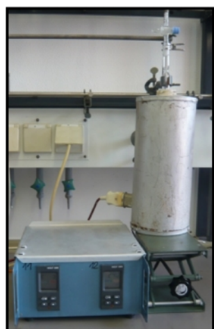
Abb. 31: Thermolyse von \text{Al}(\text{O}_2\text{CCF}_3)_3 mittels eines Röhrenofens.
