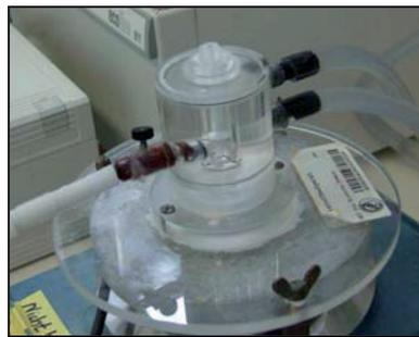
**Abbildung 6.17:** Hydrograph: Messkammer mit Elektrode sowie Temperierzuleitung und -ablauf
