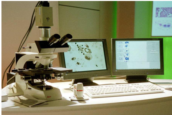
Abb. II.1: Ansicht des Labormusters mit Mikroskop, CCD-Kamera und Computer
