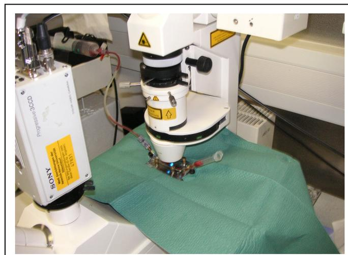
*Abb.7: Versuchsaufbau, die Strömungskammer im Laser-Scanning-Mikroskop*
