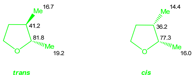
Abbildung 2.2: Literaturbekannte ^{13}\text{C} -NMR Signale von trans - und cis -Tetrahydro-2,3-dimethylfuran [63]
