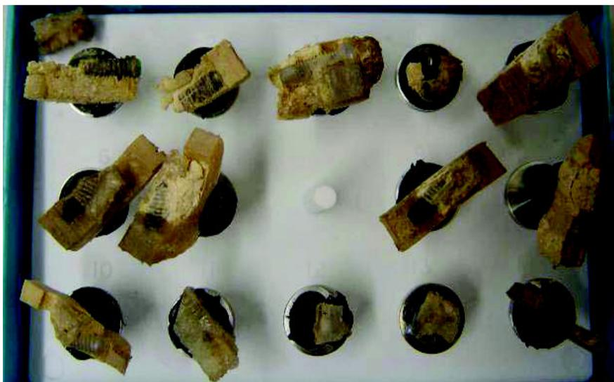
**Abb. 7: Besputterte Knochenproben auf den Proben Tellern**
