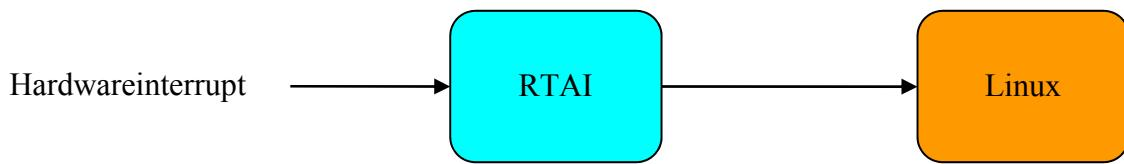
[Abbildung 3-22:](#) Adeos-Interruptpipeline für das RTAI-Linux Echtzeitsystem
