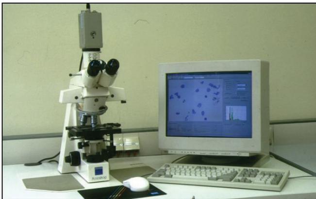
**Abbildung 6: TV-Bildanalyse-system, AutoCyte QUIC-DNA®**
