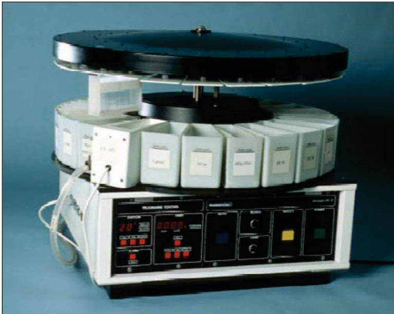
**Abbildung 11: Automat für die temperaturkontrollierte Feulgen-Färbung**
