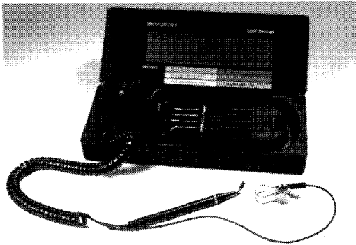
Abb. 7.15 Odontometer (Fa. L. Goof), die Referenzelektrode wird an der Unterlippe angelegt
