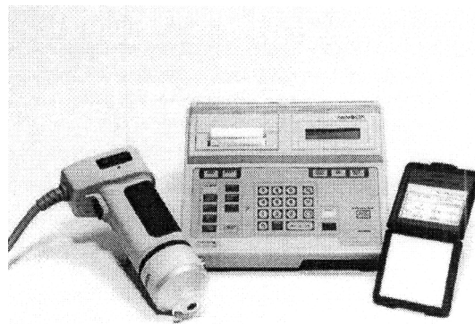
Abbildung 15: Chromameter CR-300 (Konica-Minolta, Osaka, Japan) bestehend aus der Kontrolleinheit, dem Messkopf und dem Weißstandard zur Kalibration des Chromameters
