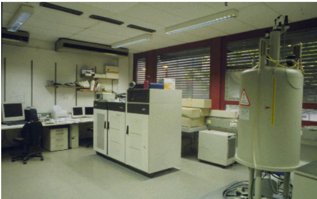
**Abb. 2.3:** 400 MHz Widebore-NMR mit Konsole und Workstation
