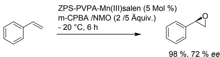
**Abbildung 1.4: Jacobsen-Epoxidierung unter Verwendung eines immobilisierten Mangansalenkomplexes**
