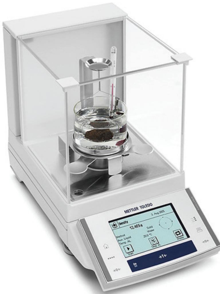
**Abb. 4.2** Mettler Toledo Analysewaage mit Dichtebestimmungs-Kit (95).
