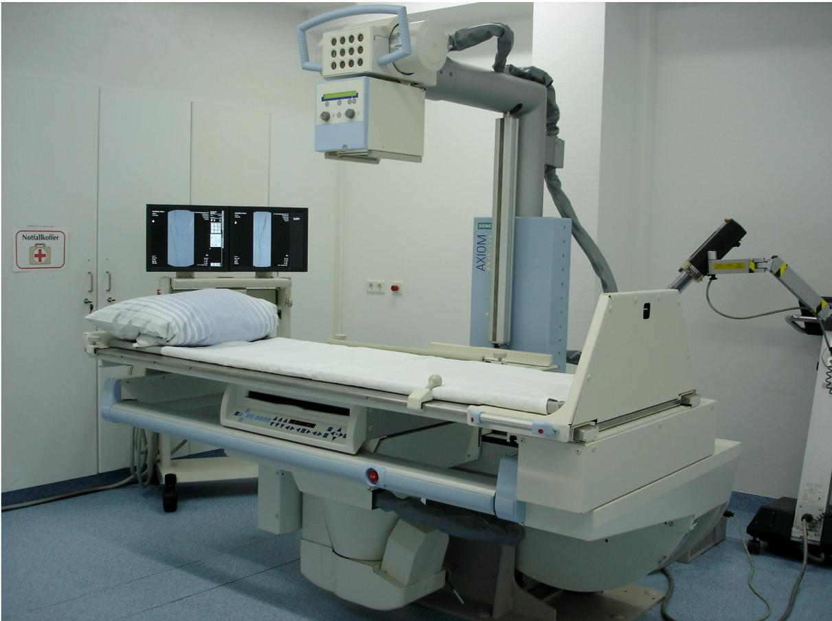
Abb. 2.1 DSA Röntgenanlage „Axiom Iconos R 200“ der Fa. Siemens
