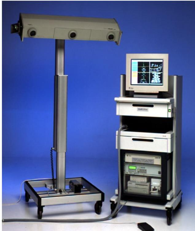
Kamera zur Verfolgung der Instrumente im Raum und Computerwagen mit ‚Workstationrechner‘ und Bildschirm
