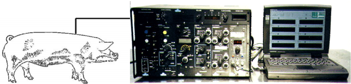
Abb. 2.5 Schematischer Versuchsaufbau. Die am Nacken des Tieres ausgeleiteten Messkatheter wurden mit einem Triton System 6 (Mitte) verbunden, wo die Signale digitalisiert und von dort zum Laptop (rechts) übertragen wurden.
