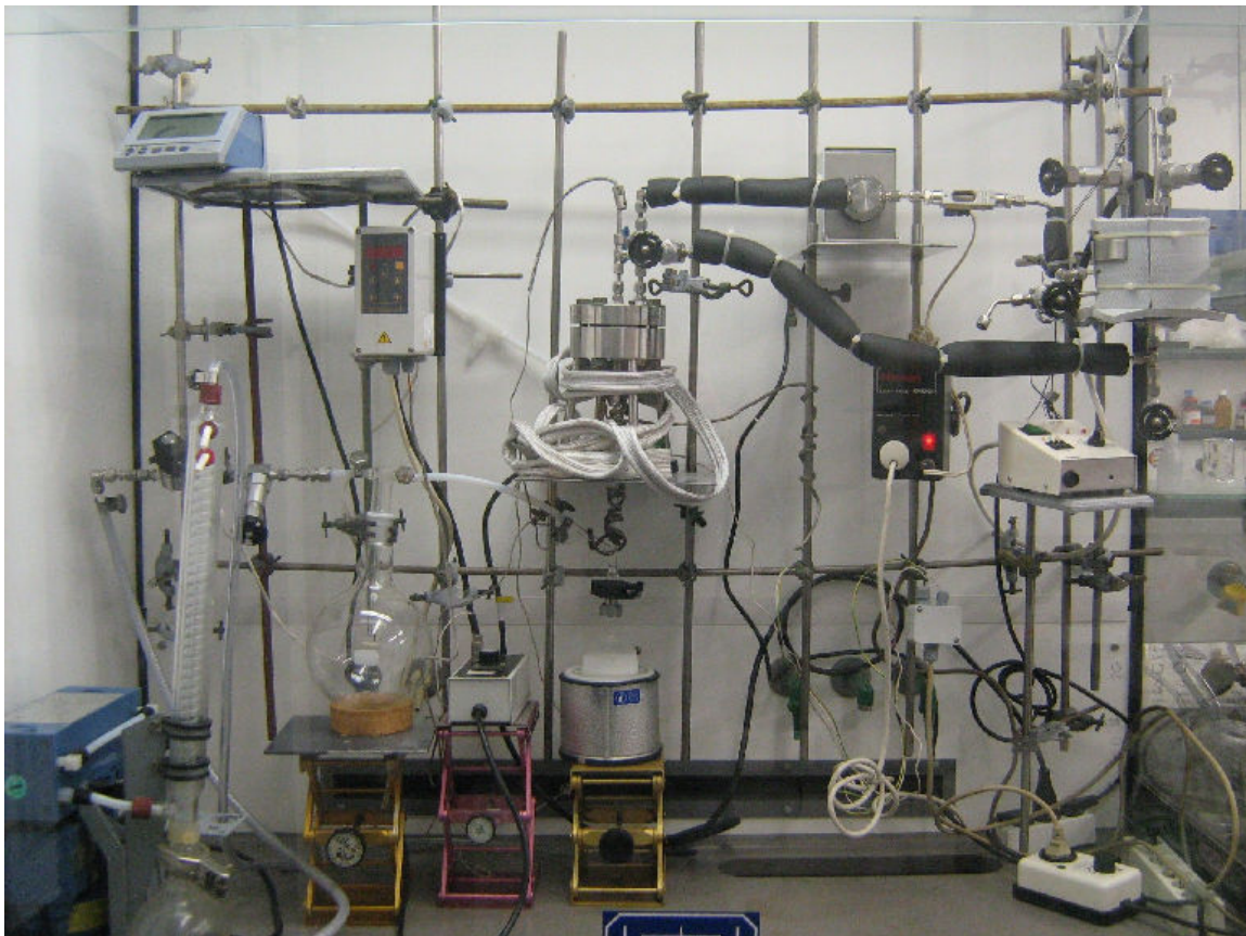
Abb. 31: Foto der Pervaporationsapparatur
