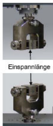
Abb. 23: Einspannbacken im Detail [51]
