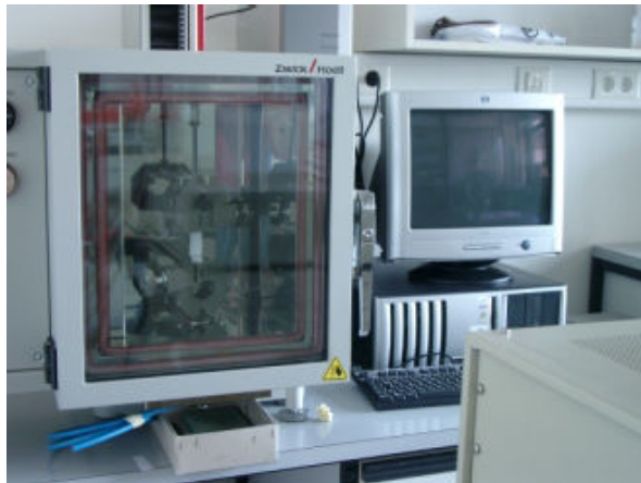
Abb. 22: Zugprüfmaschine Zwick 2.5N mit Wärmekammer [50]
