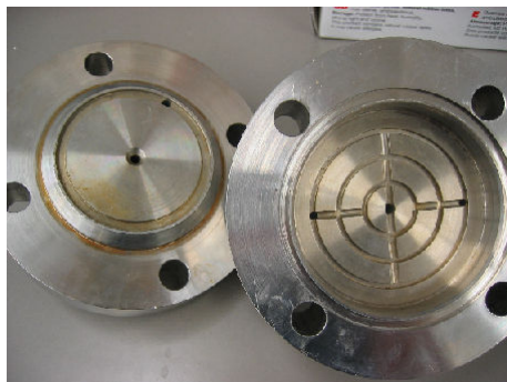
Abb. 33: Foto der Trennzelle
