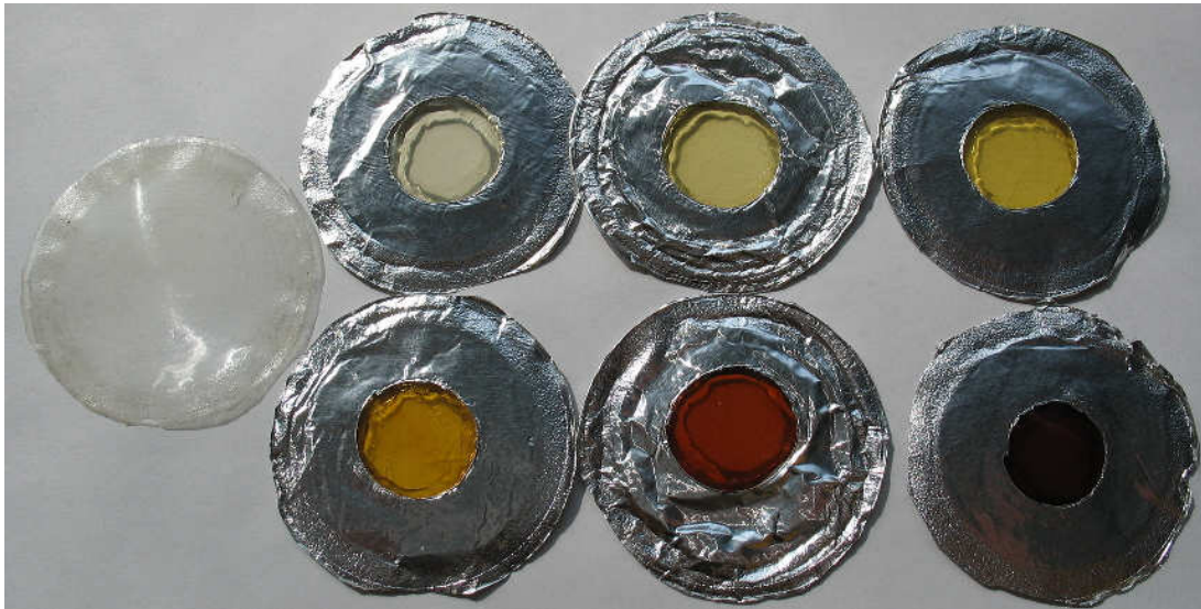
Abbildung 3.2.4: Änderung der Farbigkeit von Membranen aus 6FDA-4MPD (PI17) vor und nach Temperung (nähere Beschreibung im Fließtext)
