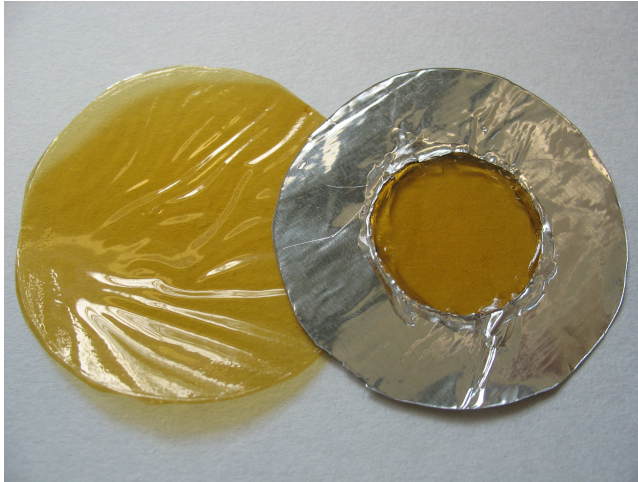
Abbildung 4.5.3: Membranen vor und nach Behandlung mit selbstklebender Aluminiumfolie und Epoxidkleber
