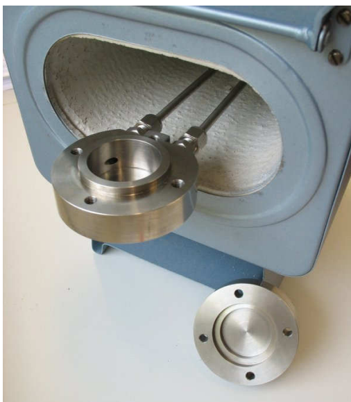
Abbildung 3.2.3: Muffelofen mit Zelle zur Temperung unter Stickstoff
