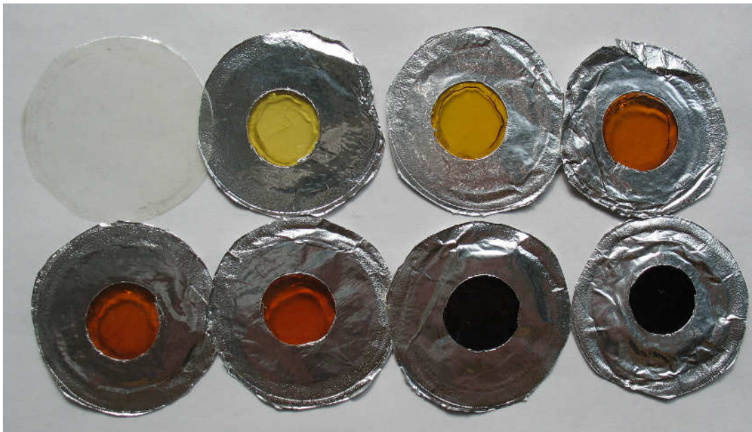
Abbildung 3.2.5: Änderung der Farbigkeit von Membranen aus 6FDA-4MPD:6FDA-DABA 4:1 (PI19) vor und nach Temperung (nähere Beschreibung im Fließtext)
