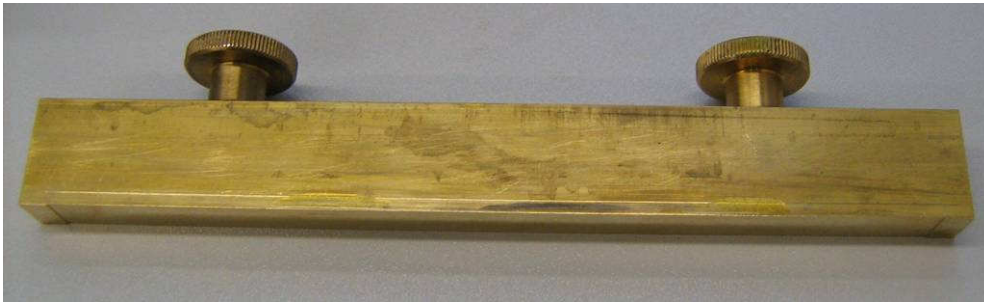
Abbildung 4.2.1: Einfache Handrakel, Spalthöhe ca. 250 \mu\text{m}
