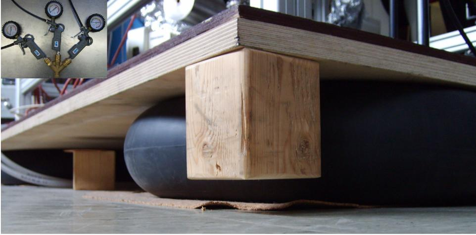
Abbildung 30: Eingesetzte Schwingungsdämpfung mit Autoreifen-Schläuchen. Die Abbildung zeigt die Kammer im angehobenen Zustand.
