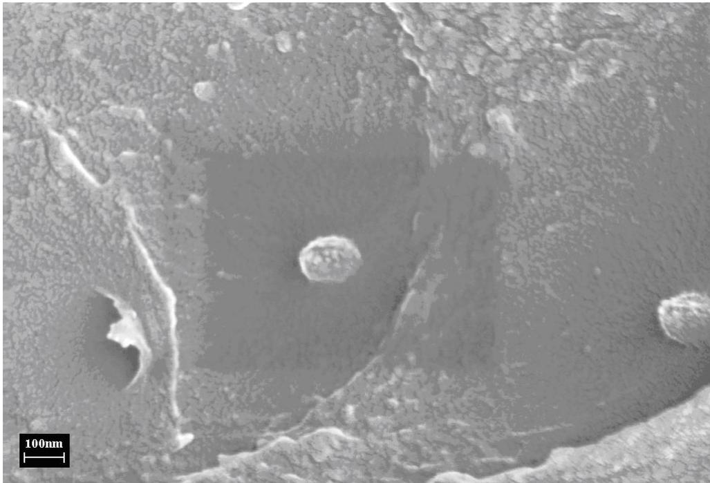
**Abb. 5.23** Vergrößerter, agglomerierter Nanopartikel aus der REM Aufnahme des 6FDA-4,4'-SDA/DABA 4:1 TiO<sub>2</sub>-Nanokomposits
