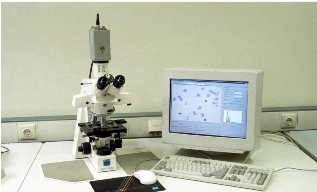
Abbildung 5. Messeinheit für die DNA-Zytometrie, bestehend aus Mikroskop, Kamera, PC und der Software Quick AutoCyte
