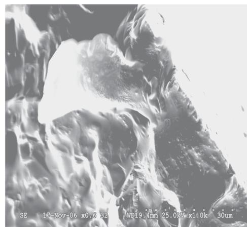
**Abb. 5.18.** Vitablock Mark II HF-geätzt
