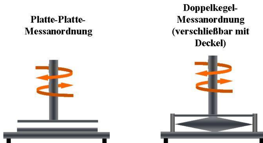
Abb. 29: Verwendete Messanordnungen zur viskosimetrischen Untersuchung der Wirt-Gast-Hydrogele. Die Verwendung eines verschließbaren Doppelkegels wurde bei Experimenten angewendet, die beheizt und über einen längeren Zeitraum verliefen, um ein Verdunsten des Lösungsmittels zu vermeiden.
