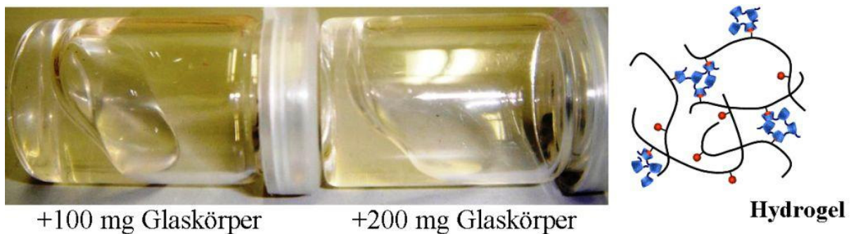
Abb. 50: Hydrogele aus 5 und 25 ( c=50 mg·mL -1 , T=20^{\circ}\text{C} ), bei welchen Wasser durch Affenglaskörpermaterial ersetzt wurde, nach 1 Minute Kippung des Probengefäßes.
