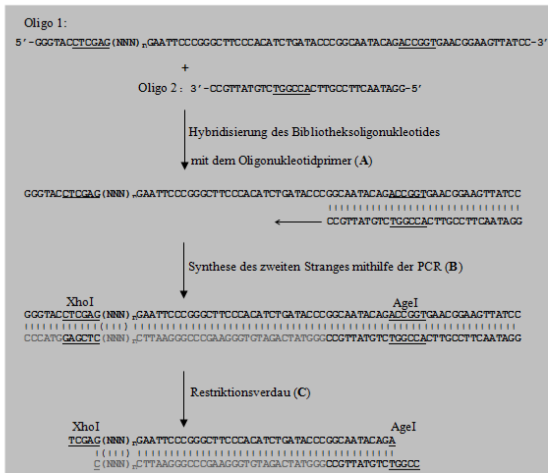
Abbildung 44: Strategie II zur Erstellung des für die Peptidbibliothek codierenden Inserts. Das Oligonukleotid, das die variable Sequenz enthält (Oligo 1) und der Oligonukleotidprimer (Oligo 2) hybridisieren miteinander (A). Anschließend wird das Hybridisierungsprodukt mithilfe einer PCR zu einem Doppelstrang aufgefüllt (B). Dieser wird durch zwei Restriktionsendonukleasen geschnitten (C) und kann in den ebenso geschnittenen Vektor eingesetzt werden. Basen, die Bestandteil der Erkennungssequenz einer Restriktionsendonuklease sind, sind unterstrichen. Durch die Polymerase aufgefüllte Basen sind in grau dargestellt. Auf diesem Weg wurden eine 5mer Peptidbibliothek ( n = 5 ) erstellt.
