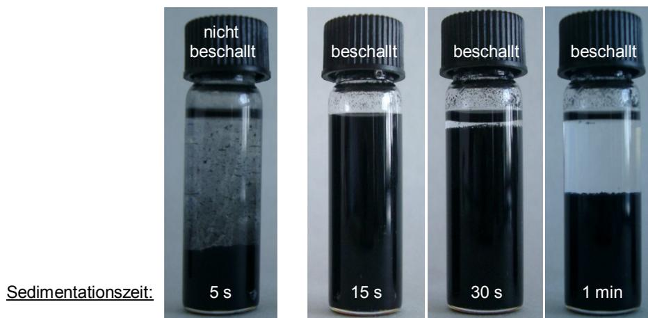
Abb. 14: Baytubes<sup>®</sup> nach 1-minütiger Beschallung mit Ultraschall in Wasser. Links: Nicht beschallte Baytubes<sup>®</sup> in Wasser (Konzentration: 1 g/ml)
