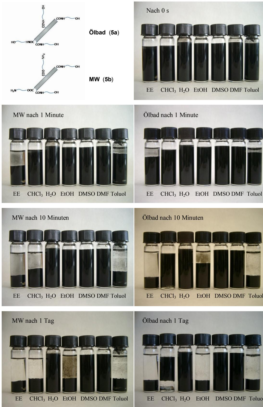
Abb. 30: Aufnahmen der Sedimentation von CNTs umgesetzt mit 6-Aminohexanol (links) in der MW (**5b**) und (rechts) im Ölbad (**5a**) nach verschiedenen Zeiten
