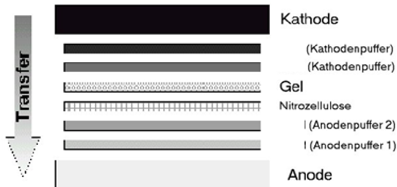
Abb. 2.4: Schematische Darstellung des Semi-Dry-Blotting-Aufbaus
