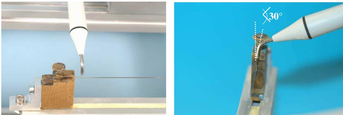
Abbildung 5 und 6: Ausrichtung des Handstücks zum fixierten Draht im 30° Winkel
