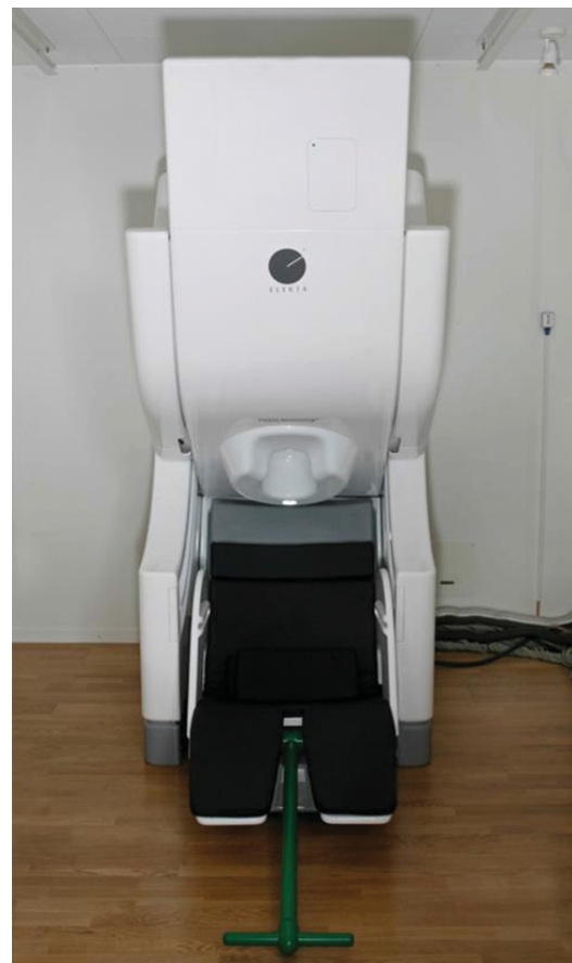
Abbildung 2: Ganzkopf-MEG-System an der Heinrich-Heine-Universität Düsseldorf (Firma Elekta Oy, Helsinki, Finnland). Mithilfe von 306 dcSQUID-Sensoren kann die neuromagnetische Aktivität von der gesamten Schädeloberfläche abgeleitet werden (Foto: Pressestelle des UKD).
