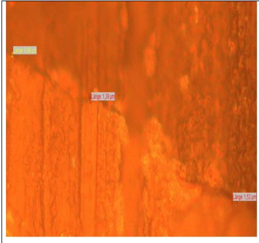
Abb. 9: Digitale Fotografie unter 40facher mikroskopischer Vergrößerung von Zahn 9 an verschiedenen Stellen der Fraktur
