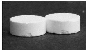
Abbildung 3.8: Magnesiumcarbonattabletten, die mit 0,1 % Magnesiumstearatzusatz tablettiert wurden.
