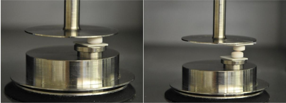
**Abbildung 63: Modifiziertes Rotationsviskosimeter zur Bestimmung der Reibungskoeffizienten Tablette-Stahl (links) und Tablette-Tablette (rechts)**
