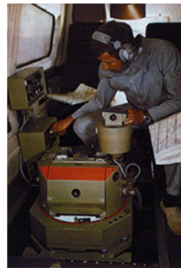
Operateur während eines Bildfluges mit einer Reihemesskamera
