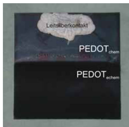
Abbildung 3.1: Objektträger (2,6 x 2,6 cm) mit PEDOT chem (ca. 350 nm; 150 Scm -1 ) nach 1000 s Beschichtung mit PEDOT aus ACN-Lösung mit 0,05 M EDOT; mit Leitsilberkontaktstelle
