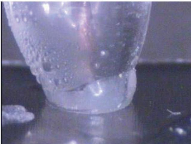
*Abbildung 113: Die Temperaturentwicklung im Metall ist so groß, dass Elektrolytreste in der Nähe (unten links) sofort auskristallisieren.*
