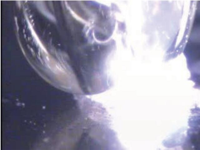
*Abbildung 136: Foto der Kapillarenspitze während eines 5s Pulses auf Niobcarbid im Natriumchlorid-Elektrolyten. Bei 100 V zündet ein Plasma (heller Lichtfleck), da die Oxidschicht aufbricht.*
