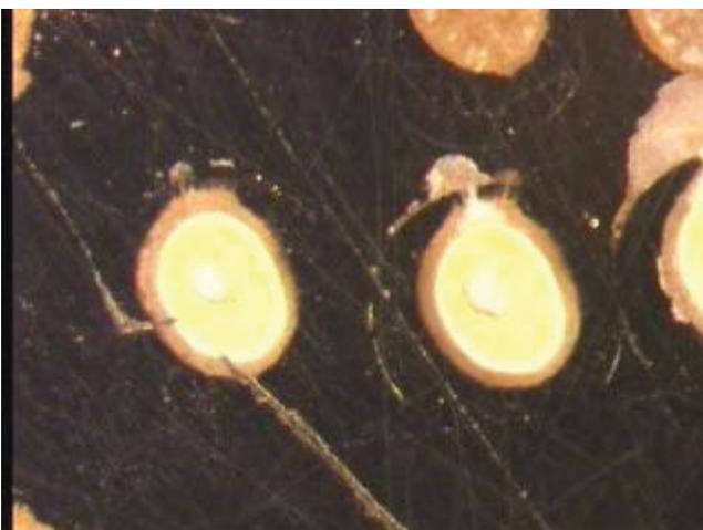
*Abbildung 118: Foto der bearbeiteten Stellen nach einem Puls auf Tantalcarbid in Natriumchlorid. Die Oberfläche ist gefärbt, nur ein schwacher Abtrag ist zu beobachten.*
