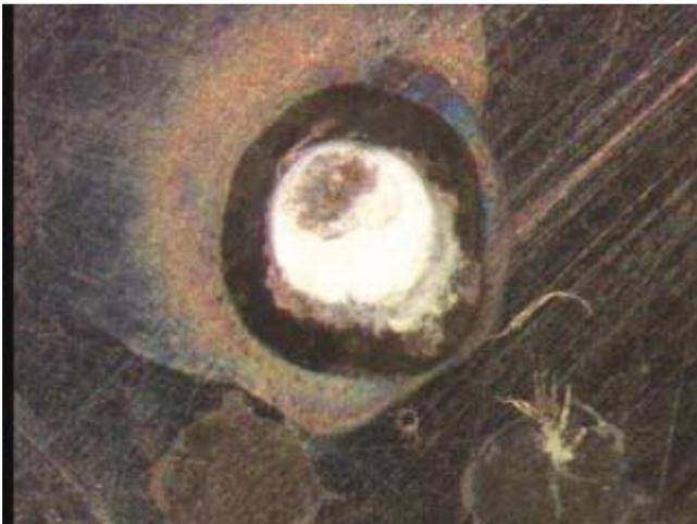
*Abbildung 137: Foto einer Stelle auf Niobcarbid nach dem Puls. Der innere Bereich ist nach der Plasmazündung glänzend.*
