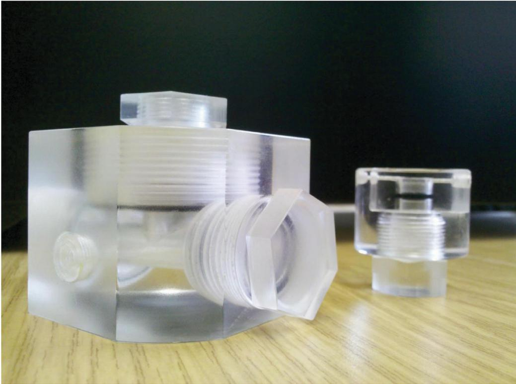
*Abbildung 12: UV/Vis-Durchflussküvette (im Vordergrund) und Fluoreszenzküvette (im Hintergrund) mit Blindschrauben zur Aufbewahrung.*
