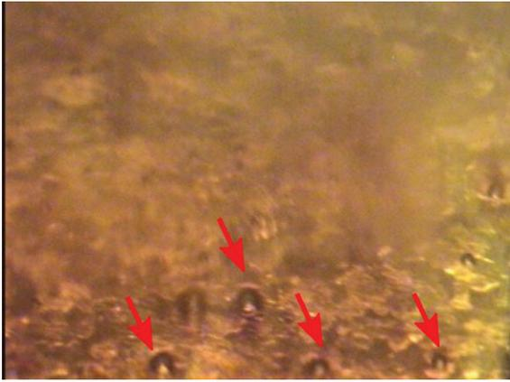
*Abbildung 67: Foto der Würfeloberfläche während eines 20 A Pulses. Die roten Pfeile zeigen auf entstehende Gasblasen.*
