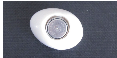
Abbildung 38: Plastik-Eiattrappe mit i.Button zur Temperatur- und Luftfeuchtemessung
