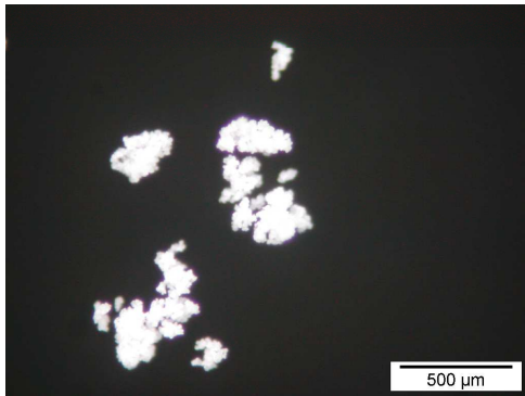
Abbildung 3-25: lichtmikroskopische Aufnahme von Polyethylen, das mit gemahlenem FK 9 hergestellt wurde
