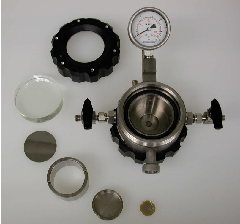
Abbildung 6-5: Fensterautoklav im geöffneten Zustand
