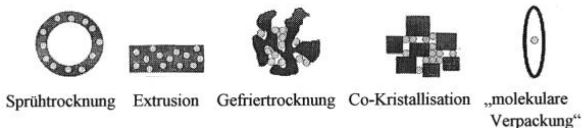
Abb. 3: Vereinfachte Darstellung der Verteilung der verkapselten Substanzen je nach Verkapselungsprozess
