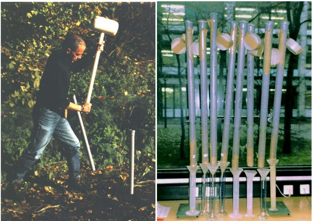
Abbildung 11: Entnahme von Profilsegmenten auf der Versuchsfäche in Hagen (links) und in PE-Rohren aufgenommene Profilsegmente während des Elutionsversuchs (rechts).
